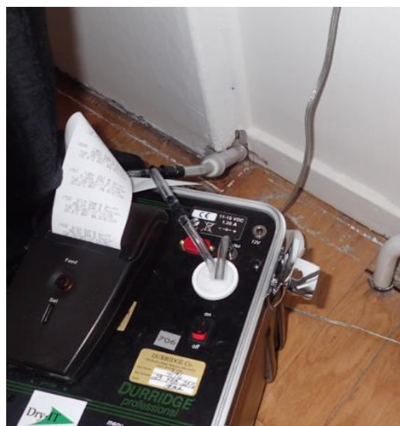
Radonmätning i golvvinkel vid påvisat luftläckage, vardagsrum. Radonhalt 308 Bq/m 3 .
