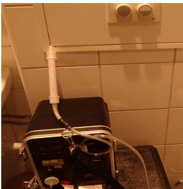
Radonmätning "sniff" vid luftläckage vid inklädnad bakom WC-stol. Radonhalt 415 Bq/m 3 .
